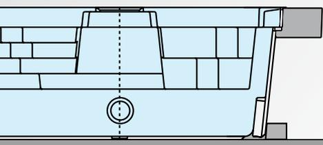
Einbau freitragend mit Überlaufrinne: Wandverstreben aus Stahl.
