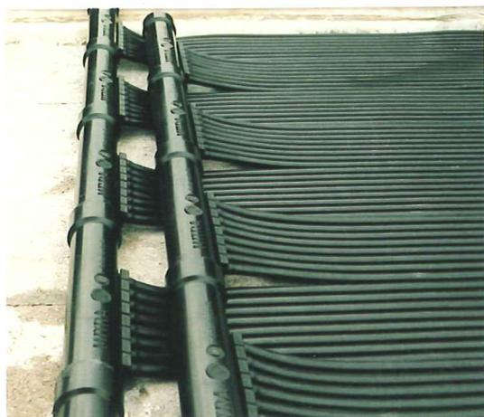
Les tubes collecteurs à emboîtement des absorbeurs **MITRAS** n'occasionnent aucun espace intermédiaire et permettent de réaliser une surface d'aspect compact. Grâce aux éléments d'une largeur de 25 cm, les toitures peuvent être équipées à la perfection, à savoir par exemple largeur de la toiture 3,75 m - largeur des capteurs 3,75 m.
